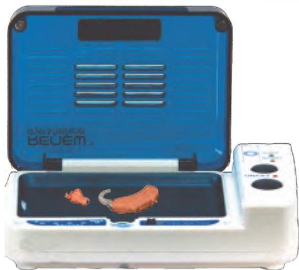
温められた空気が補聴器の湿気を蒸発させます
